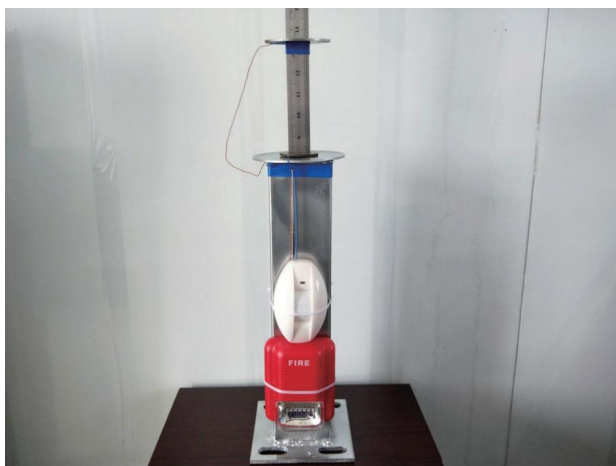
图 5.3.1-1 内支撑脚手架变形智能监测、报警装置的加工制作
