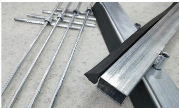
图 5.4.3-2 防止现浇混凝土剪力墙烂根的装置的加工制作
